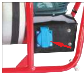
Вставьте вилку силового провода электродрели в розетку на раме. Убедитесь в надежности соединения вилки с розеткой.
