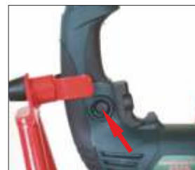
Отрегулируйте нужную скорость вращения насадки перед применением и нажмите блокиратор. Чтобы снять блокировку нажмите кнопку повторно.
