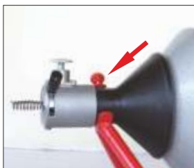
Вставьте ручное устройство в сборе в соответствующее положение зажима и заблокируйте винт.
