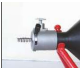
Устройство автоматической подачи проталкивает и вытягивает спираль автоматически.
